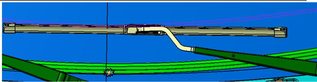
(2) 然后安装副驾侧雨刮，刮刷离黑边最近距离在黑边以下 5mm 左右。如下图示：
