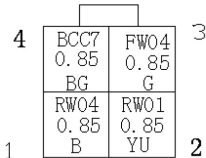
后雨刮电机接插口定义：(线束端)
