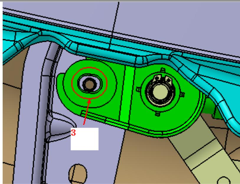
“3” 雨刮“一”形孔，安装 M6 六角法兰面螺栓。
