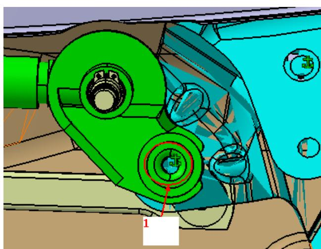
“1” 雨刮圆孔，安装 M6 六角法兰面螺栓，此为主安装定位点。
