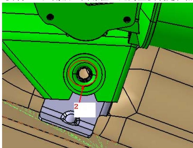
“2” 雨刮圆孔，安装 M6 六角法兰面螺栓。
